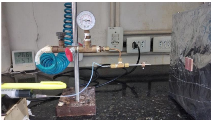
Figura 17. Sistema de Solution Blow Spray montado para deposição do filme de PAni/PLA/ZnO.
