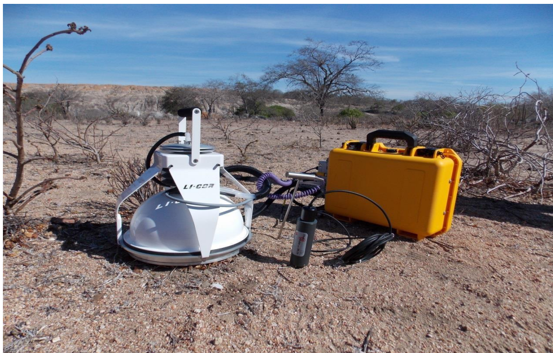
Figura 14: LI8100A utilizado na medição com a câmara de 20 cm. Fonte: Alexandre D'Andrea (2016).
