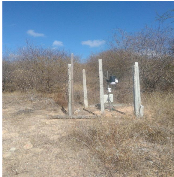
Figura 15: Estação Meteorológica Davis Vantage Pro2 na Fazenda Salambaia.
