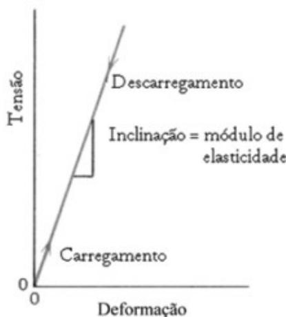
Figura 3.3 – Diagrama tensão-deformação da deformação elástica, em que o material volta a sua forma inicial no momento de descarga.
