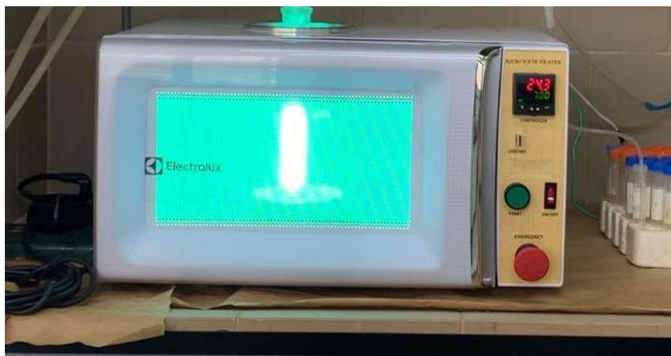
Figura 13: acionamento da lâmpada por micro-ondas para a degradação dos TPHs.
