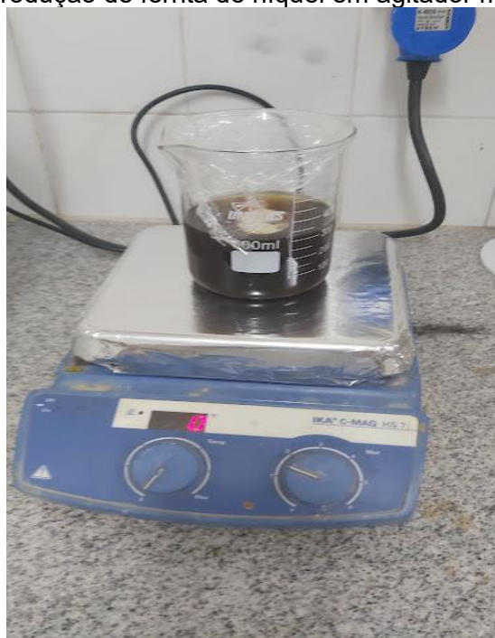
Figura 3 - Solução 1, para produção de ferrita de níquel em agitador mecânico
