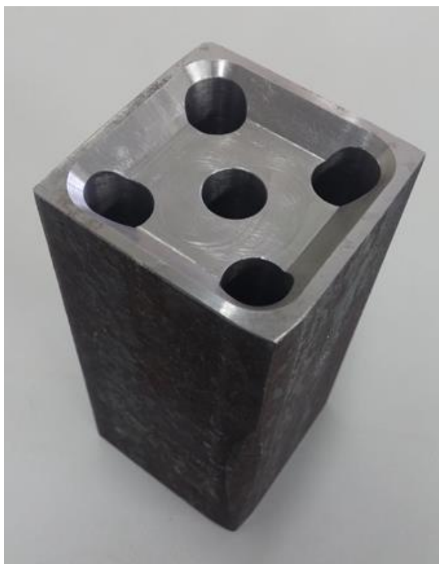
Figura 3.2 – Molde para obtenção dos lingotes.
