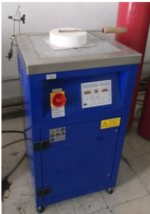
Figura 3.1– Forno de indução sem atmosfera controlada.
