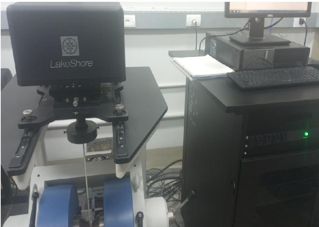
Figura 56 – Foto do Magnetômetro de Amostra Vibrante (VSM), localizado no LNMS.
