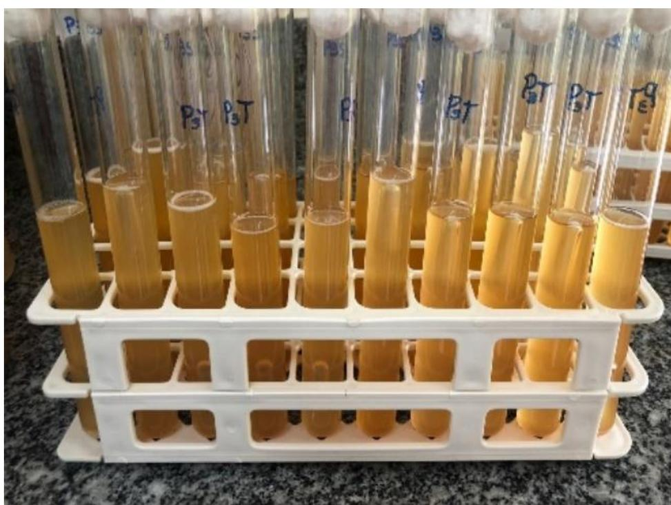
Com o resultado positivo do teste, em que se observa através da produção de gás, é necessário fazer o teste confirmativo. Nele são preparados 10 tubos com meio de cultura verde brilhante 2% para a contagem de *E. coli*. (EC) e 10 tubos com o meio EC para a contagem de coliformes termotolerantes.
