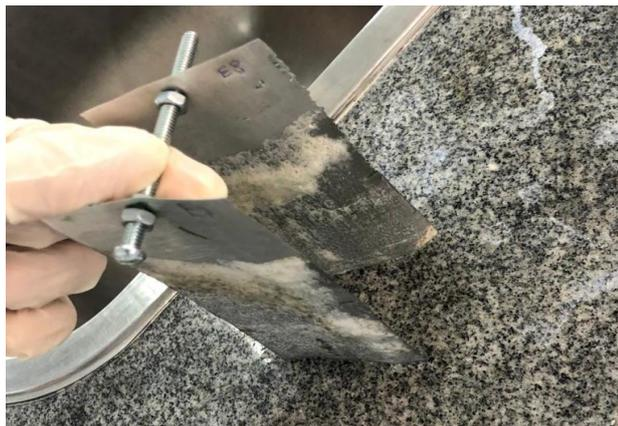
Na Figura 5.2 pode-se observar que os eletrodos E7 e E8 sofreram oxidação e, conseqüentemente, perde de massa após a aplicação da corrente elétrica, assim como os eletrodos E3, E4, E11 e E12. Enquanto os eletrodos E1, E2, E5, E6, E9, E10 sofreram redução, ou seja, aumento de massa.
