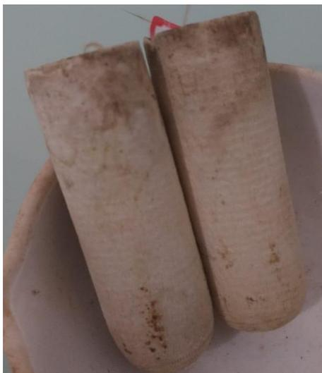
Após a secagem na estufa por 1 h à 103/105°C, os cartuchos são colocados em suporte e pendurados nos ganchos (Figura 4.14) do extrator de óleos e graxas. O processo inicia quando o extrator atinge 110°C, pois passa do ponto de ebulição do N-Hexano (63°C). Com isso os cartuchos são submersos e permanecem por 30 min.
