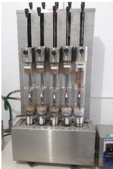
Posteriormente, os copos são retirados do extrator e colocados na estufa à 105°C, por 30 min, para assim secar todo o resíduo ainda presente. Por fim, eles são resfriados em um dessecador e pesados novamente na balança analítica, como mostra a Figura 4.15.
