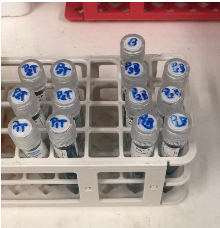
Em seguida adiciona-se 2 mL de solução padrão de hidróxido de Sódio no tubo e agita-o. Por fim adiciona-se o conteúdo do sachê de pó PhosVer 3 ao tubo, agita-o e após 2 min é feita a leitura no espectrofotômetro (DR6000), utilizando o programa específico para o Fósforo total.
