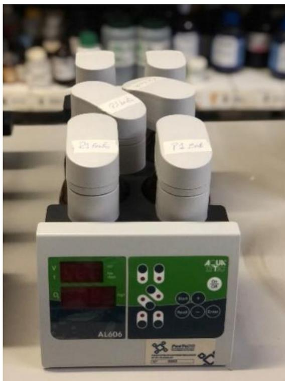
Em seguida os equipamentos são ligados, para serem iniciadas as leituras de DBO e são colocados na incubadora (Figura 4.11) à 20°C por 5 dias. No final do quinto dia, eles são retirados da incubadora para que assim seja feita a última leitura.
