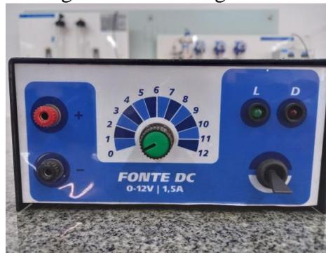
A fonte utilizada nos processos possui potenciais de saída de tensão variando de 0 à 12 volts e trabalha a corrente contínua de 1,5 ampères.
