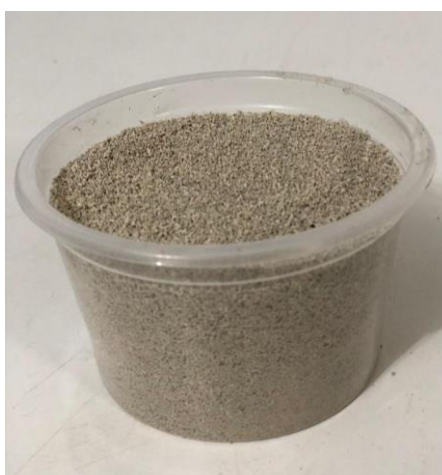
Figura 3: EVA utilizado nas argamassas estabilizadas.
