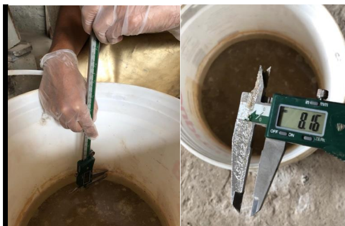
Figura 24: Medição da redução da lâmina d'água da argamassa com 50% de EVA após 72 h de estabilização.
