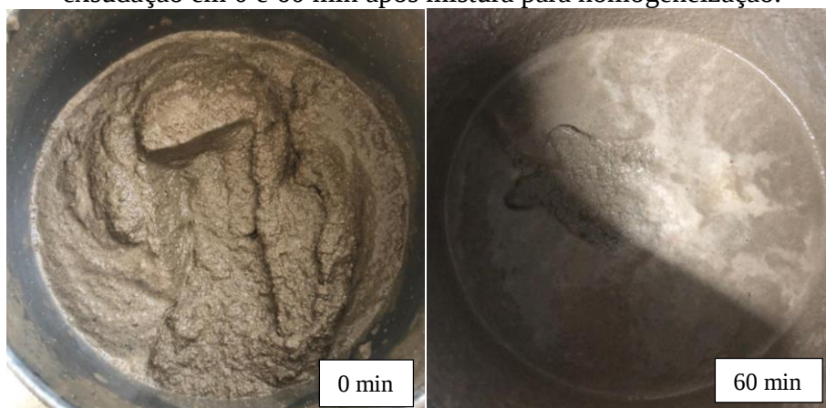
Figura 23: Argamassa com 50% EVA incorporado seco em 72 h de estabilização com exsudação em 0 e 60 min após mistura para homogeneização.
