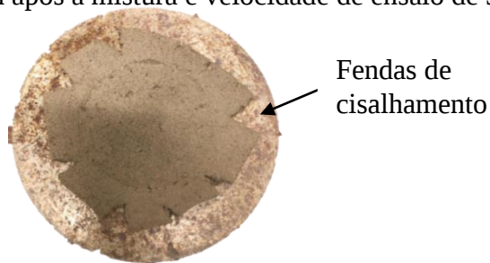
Figura 34: Argamassa 20%MC/ 10%EVA (EVA incorporado seco) com fendas de cisalhamento interno nas suas bordas laterais após ensaio de squeeze flow no tempo de 10 min após a mistura e velocidade de ensaio de 3mm/s.
