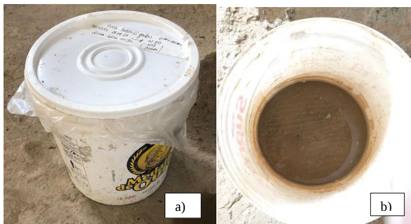
Figura 14: (a) Recipiente com argamassa em estabilização. (b) Argamassa com a lâmina d'água.
