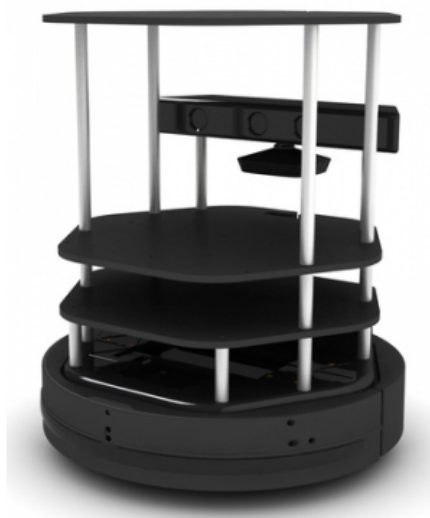
Figura 6: Robô terrestre de modelo Turtlebot 2, fornecido pelo laboratório para criação do dataset LaSER. O robô originalmente não vem com a câmera kinect, porém foi adaptada para solucionar nossas necessidades.
