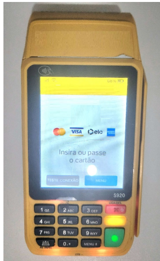
Figura 2: POS maquininha de cartão de crédito com leitor de tarja magnética, leitor de chip, teclado e impressora de recibo
