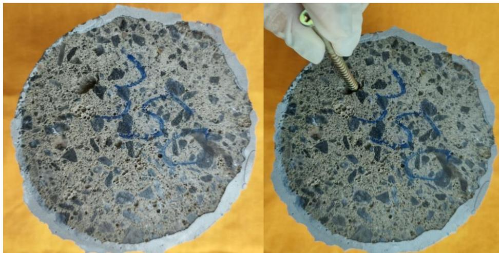
Figura 5. 11 – Presença de bolhas de ar nas amostras do C350
