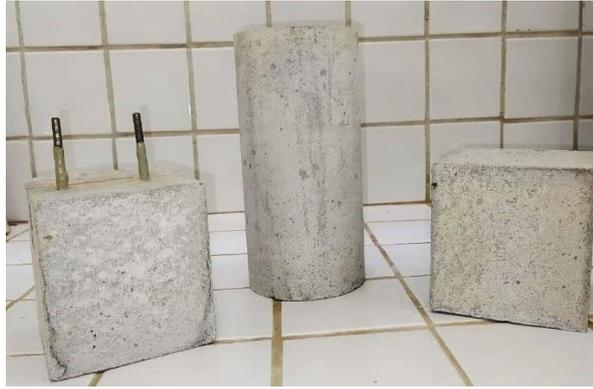
Figura 4. 1 – Corpos de prova utilizados na pesquisa: cúbicos (10 x 10 x 10) cm com e sem armaduras e cilíndricos (10 x 20) cm.
