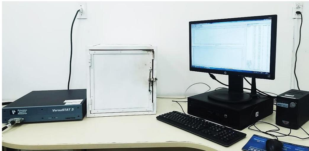
Figura 4.5 – Potenciostato de bancada e gaiola de Faraday utilizados nas medidas eletroquímicas
