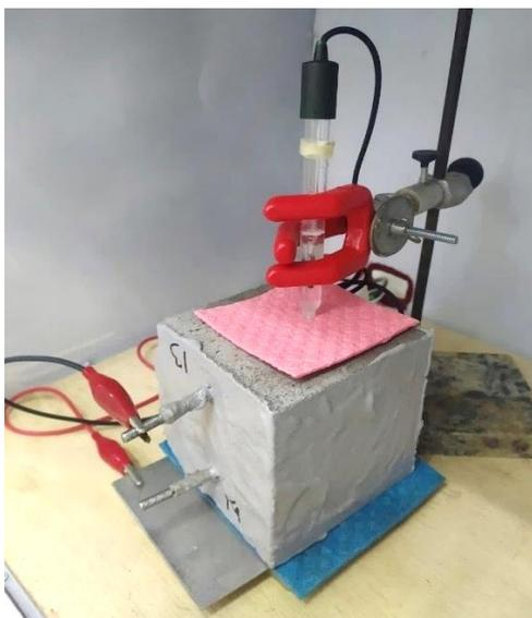
Figura 4. 6- Montagem do arranjo dos eletrodos e CP para o monitoramento eletroquímico
