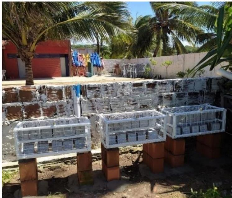
Figura 4. 12 – Gaiolas com os corpos de prova em exposição natural.
