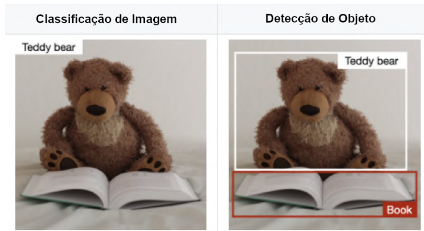
Figura 6: Representação da classificação de imagem e detecção de objetos
