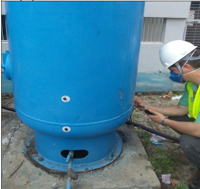
Foto 08 – Medição de espessura de chapa do tampo por ultrassom.
