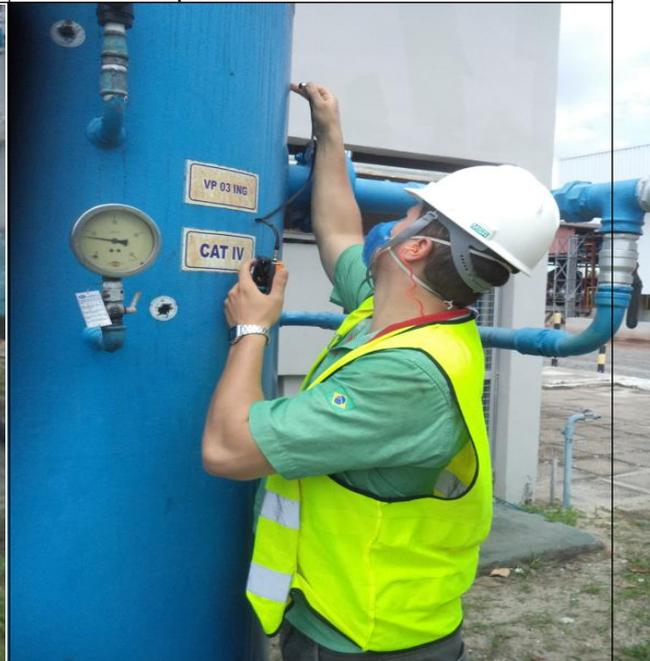
Foto 07 – Medição de espessura de chapa do tampo por ultrassom.
