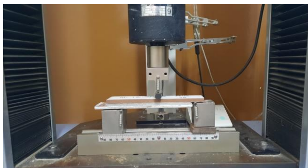
Figura 13 – Posicionamento da amostra sanduíche na máquina para o ensaio MMF (Fonte: Autora, 2022).
