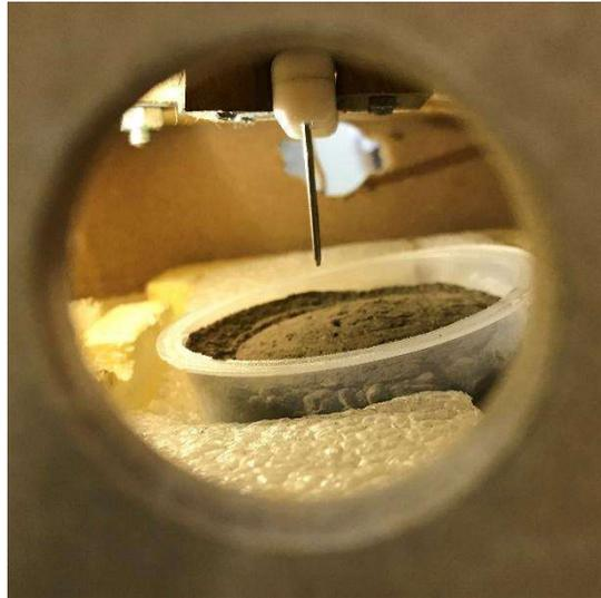
Figura 6: Inclusão da ponta SH-1 no interior da amostra de solo.
