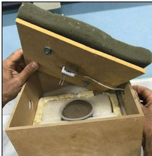
Figura 5: Acomodação da amostra e sensor SH-1 para fechamento da câmara térmica e início de coleta dos dados.
