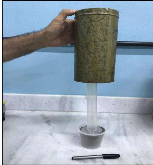
Figura 4: Homogeneização e compactação da amostra de solo para inserir no analisador de propriedades térmicas - KD2 Pro.
