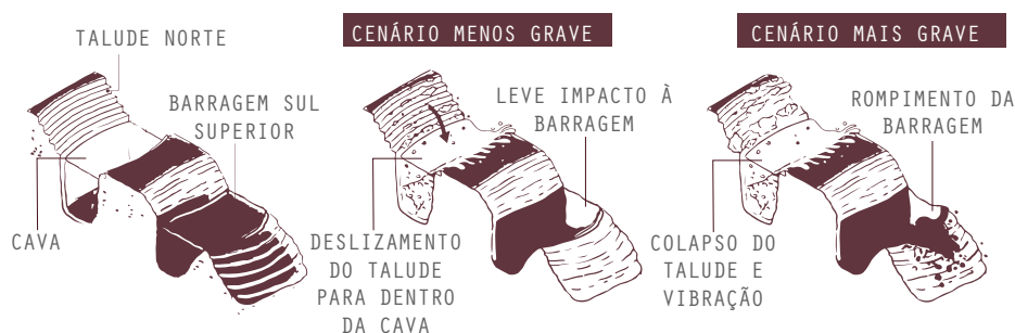
Figura 10 – Instabilidade do talude e da barragem. Fonte: Elaborado pela autora (2021).
