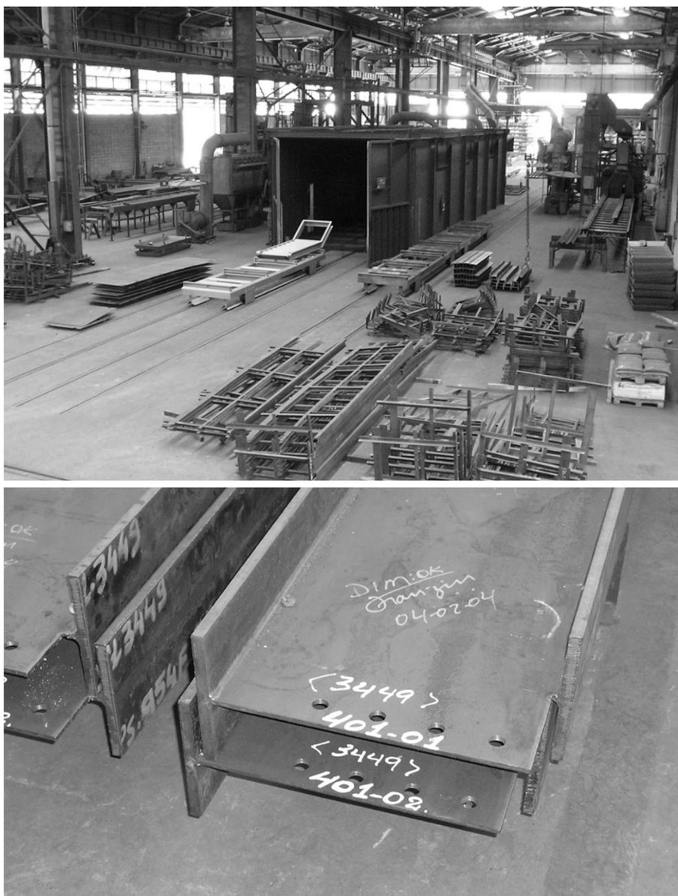
**Figura 29 e 30** - Registro da visita ao galpão de fabricação da Empresa Pórtico e perfil metálico utilizado na estrutura do Conjunto Paulo Freire. Os estudos sucessivos da Usina e depois em parceria com a Pórtico levou a uma otimização nos perfis, feito de chapas dobradas soldadas ao invés de perfis laminados. A troca possibilitou uma estrutura mais leve e econômica.
