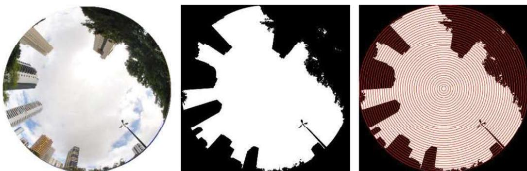
**Figura 9 – (a) Imagem hemisférica; (b) Conversão em pixel 0 e 255; (c) Inserção de 36 anéis concêntricos. (Fonte: Adaptado de Middel *et al.*, 2017)**
