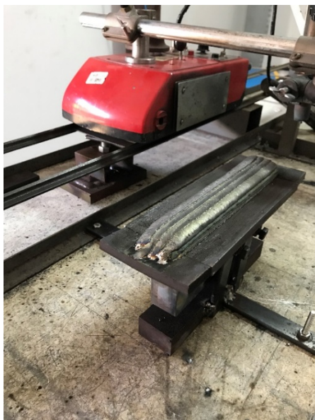
Figura 48 - Distribuição dos cordões de solda do amanteigamento ao longo do comprimento do metal de base.
