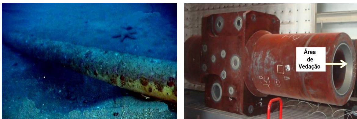
Figura 28 - Corrosão em componentes submarinos.
