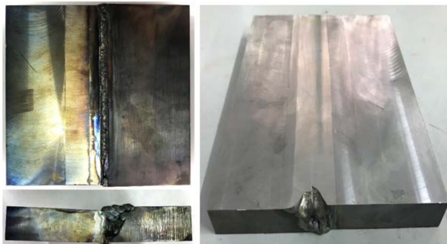
Figura 52 – (a) Passe de raiz e perfil da solda de enchimento de uma das JSD ASTM A182 F22-Inconel 625-ASTM A36 (b) JSD retificada.
