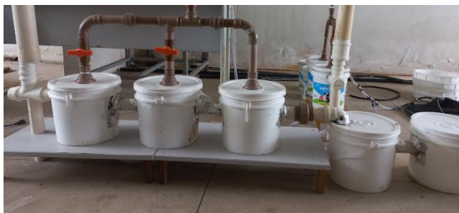
Figura 4.2: Sistema de biodigestores em série confeccionados
