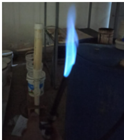
Figura 5.2: Chama produzida pela queima do biogás
