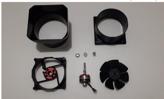
Figura 4.16 Componentes da seção de propulsão do ar do protótipo de gerador termoeletrico de exaustão automotiva (TEGea)
