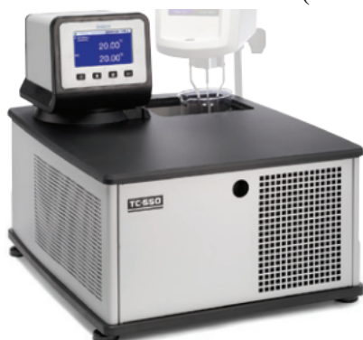
Figura 4.17 Banho termostático da BROOKFIELD modelo TC-550 para resfriamento do permutador de calor da fonte fria (CHX) do protótipo de (TEGea)
