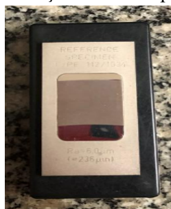
Figura 4.28 Bloco padrão de calibração do rugosímetro portátil da TAYLOR HOBSON modelo SURTRONIC 25 para calibração do sensor perfilométrico.
