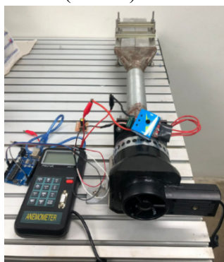
Figura 4.15 – Vista parcial da bancada experimental para teste do protótipo de gerador termoeletrico de exaustão automotiva (TEGea)
