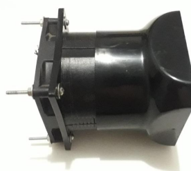
Figura 4.16 Componentes da seção de propulsão do ar do protótipo de gerador termoeletrico de exaustão automotiva (TEGea)
