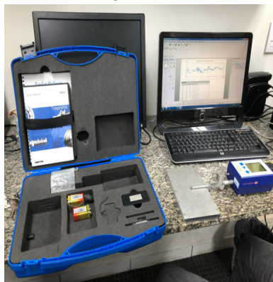
Figura 4.26 Rugosímetro portátil TAYLOR HOBSON modelo SURTRONIC 25 realizando teste de rugosidade transversal do permutador de calor HHX do TEGe
