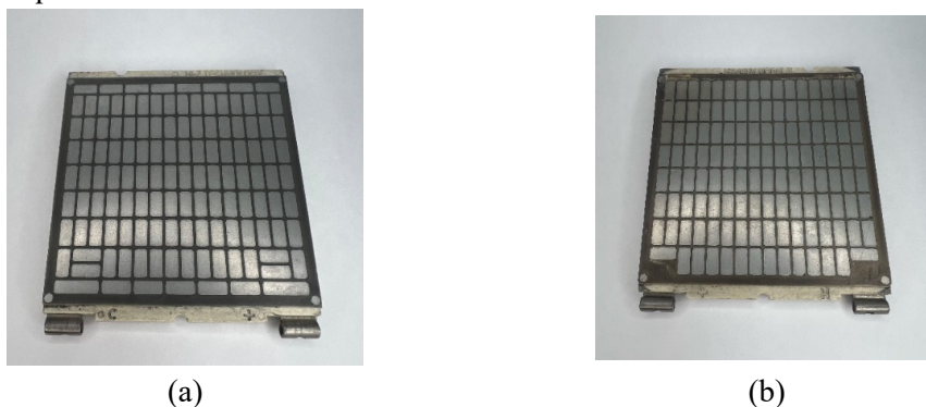
Figura 4.8 Módulo termoeletrico Hz-14HV do fabricante Hi-Z technology (a) Lado frio (b) Lado quente
