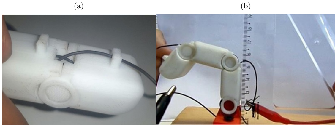
Figura 39 – Modelo 3D impresso em PLA com adição de mola torcional: (a) Montagem das falanges distal e media e (b) Perpendicularidade da base do protótipo do dedo humanoide
