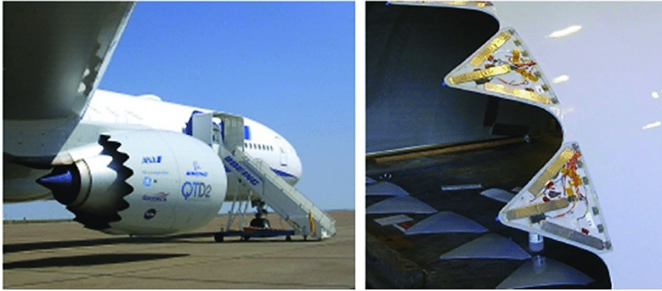
Figura 19 – Testes de voo em escala real do mecanismo VGC acionado por LMF em um Boeing 777-300ER
