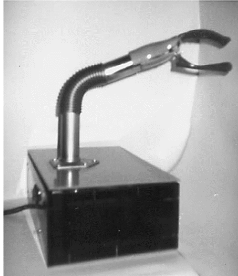
Figura 21 – Garra atuada por LMF utilizada para limpeza de campos minados
