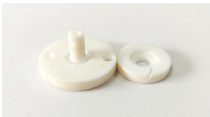
Figura 65 – Partes principais dos suportes mecânicos fabricados com Teflon ®
