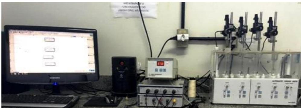
**Figura 6:** Banho de órgãos e sistema de aquisição de dados do LACONCHA (local de realização da pesquisa).
