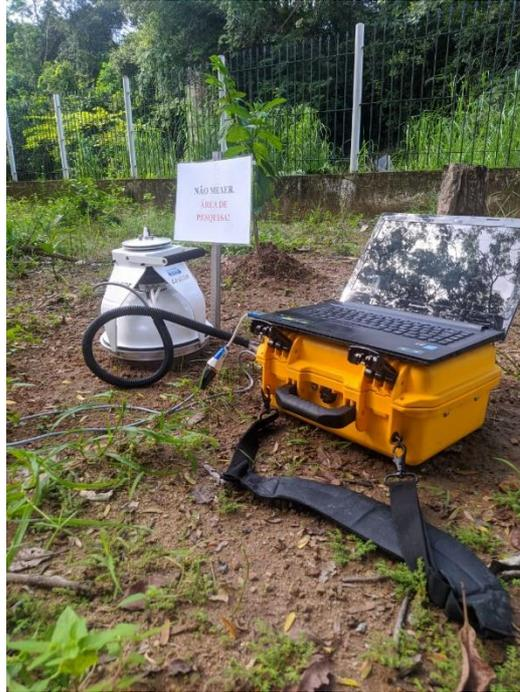
Figura 2: Medidor móvel de fluxo de CO<sub>2</sub>, LI8100A – IRGA.
