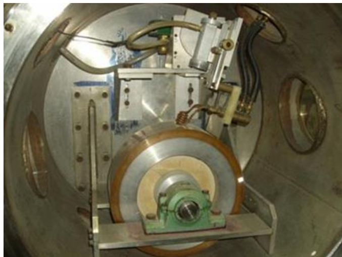
Figura 5.2 – Máquina tipo MBII desenvolvida no Laboratório de Solidificação Rápida da Universidade Federal da Paraíba.
