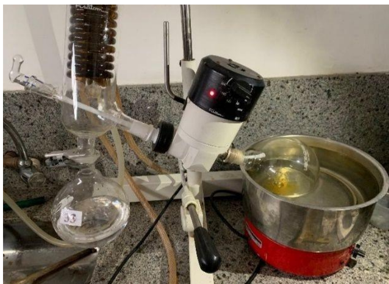
Figura 4. Evaporador rotativo fazendo a evaporação do hexano
