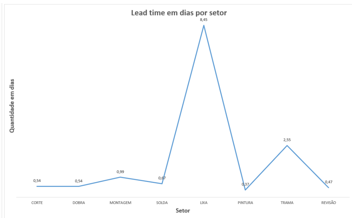
Figura 7 - Lead time dos produtos em dias com nova configuração após estudo de balanceamento
