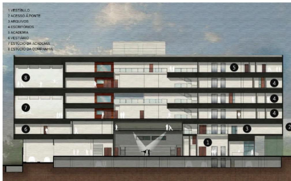
Figura 35 - Corte esquemático HBCD
