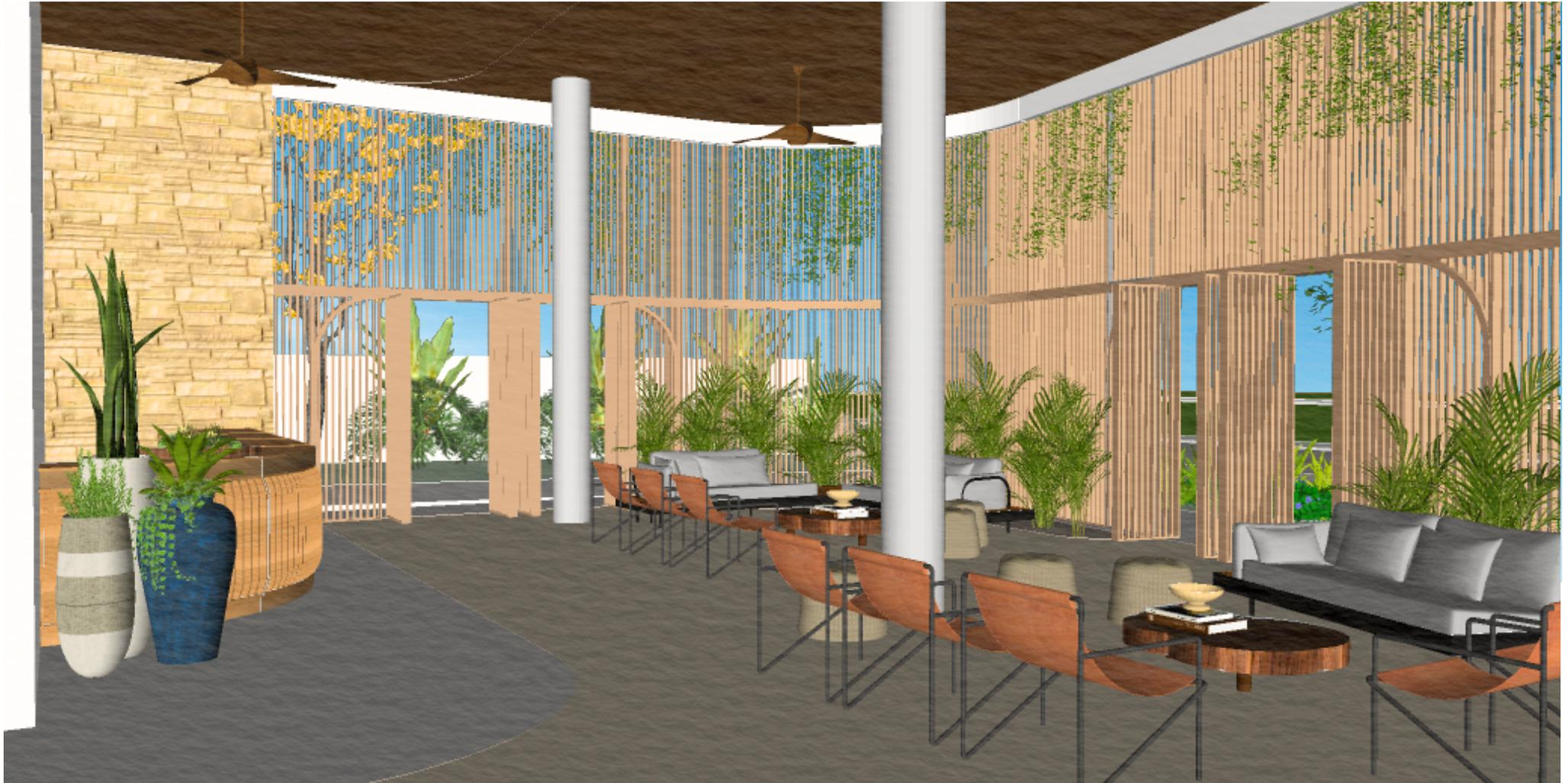
*Os brises foram utilizados na fachada para possibilitar a permeabilidade visual para o espaço externo possibilitando o aproveitamento da luz e ventilação natural. A recepção foi pensada como um espaço de transição entre o externo e interno.*
