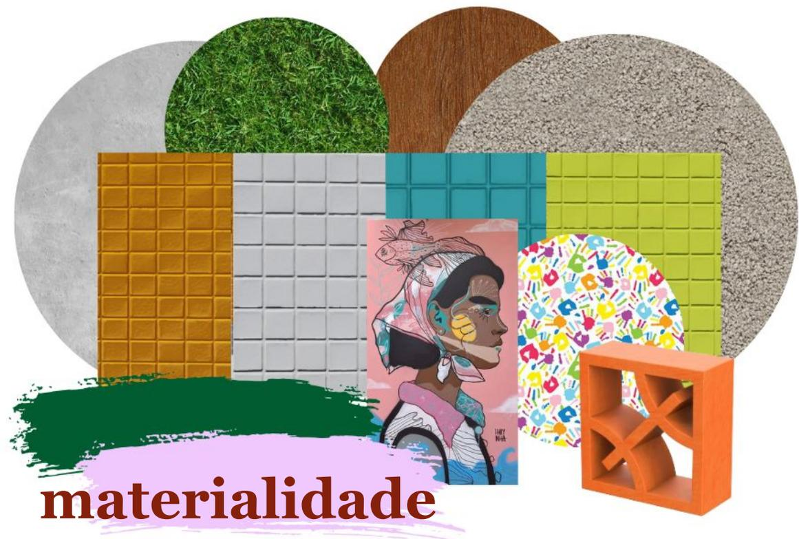
Para a materialidade foi pensado na união da cor com o natural. Nos pisos é associado o uso de revestimento drenante, concreto de alto desempenho (na cor natural e pintado) e grama santo agostinho. Nas paredes dos blocos foi utilizado revestimento cerâmico como forma reduzir a constante manutenção com pinturas. Dessa forma, foi escolhido uma cor base (cinza claro) e cores para destaques (amarelo, laranja e azul) que associado ao jogo de volumes nas fachadas agregam identidade aos blocos.
