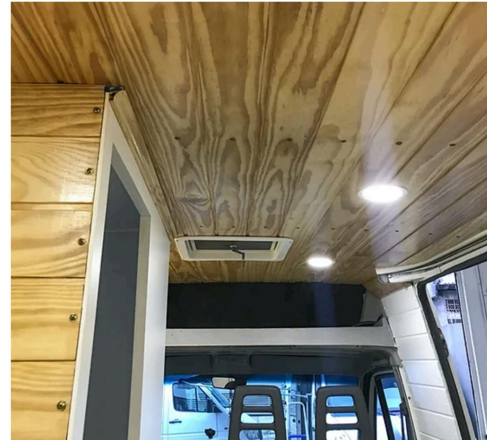
Figura 32 - Acabamento do forro e do teto em madeira Pinus.
