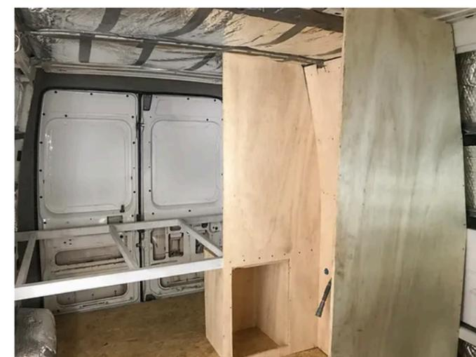
**Figura 25** - Estrutura em compensado naval para o banheiro.
