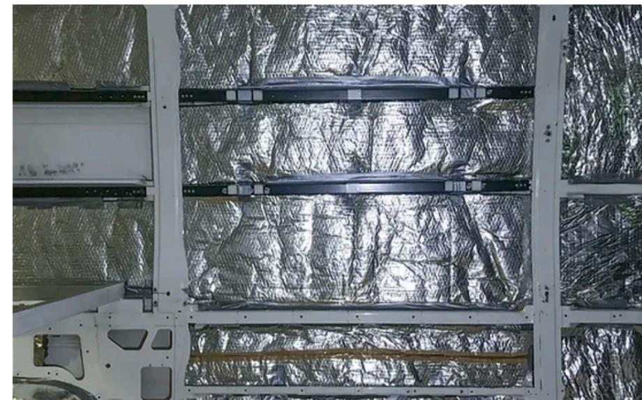
**Figura 24** - Isolamento térmico utilizando a lã de rocha aluminizada.
