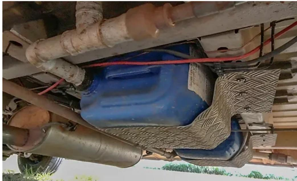
**Figura 41** - Caixa de água servida localizada abaixo do chassi do veículo.
