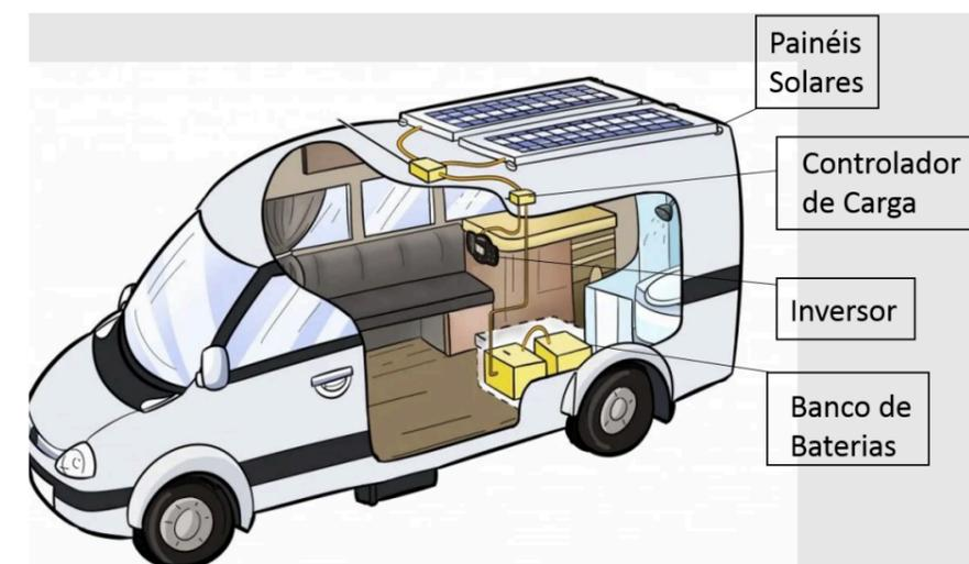
Figura 08 - Sistema *Off-Grid* em um *motorhome*.
