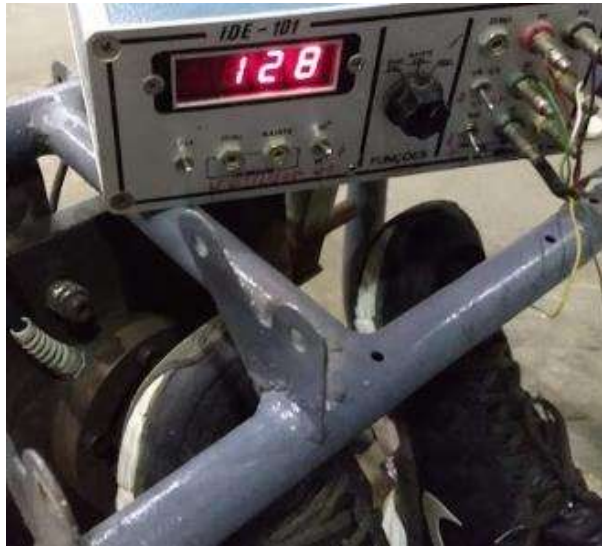
Figura 5: Teste para aquisição da força de acionamento com célula de carga
