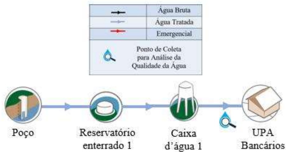
Figura 12 - Fluxograma do sistema de abastecimento de água da UPA Dr. Lindbergh Farias (Bancários)
