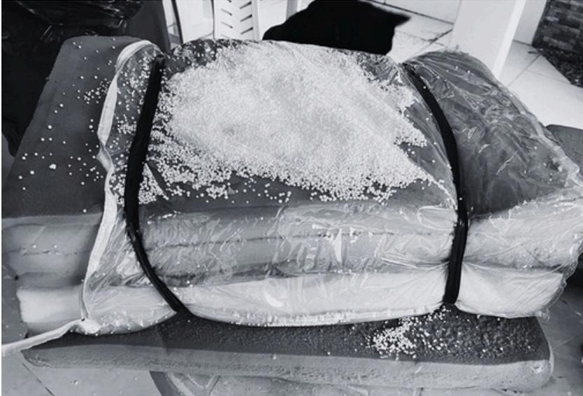
**1. Primeiro teste do assento de espuma com círculo preenchido com bolinhas de isopor.**
