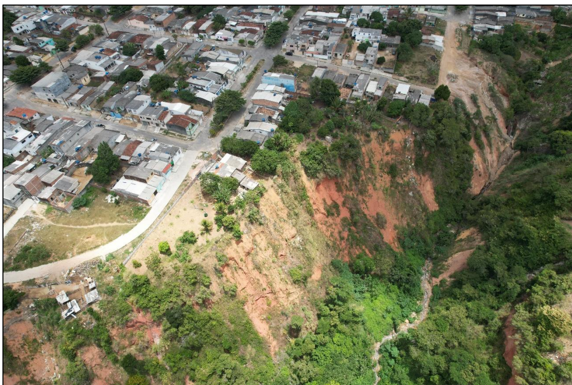
Figura 50 Voçoroca próximo a moradias periurbanas em Garanhuns, Pernambuco.
