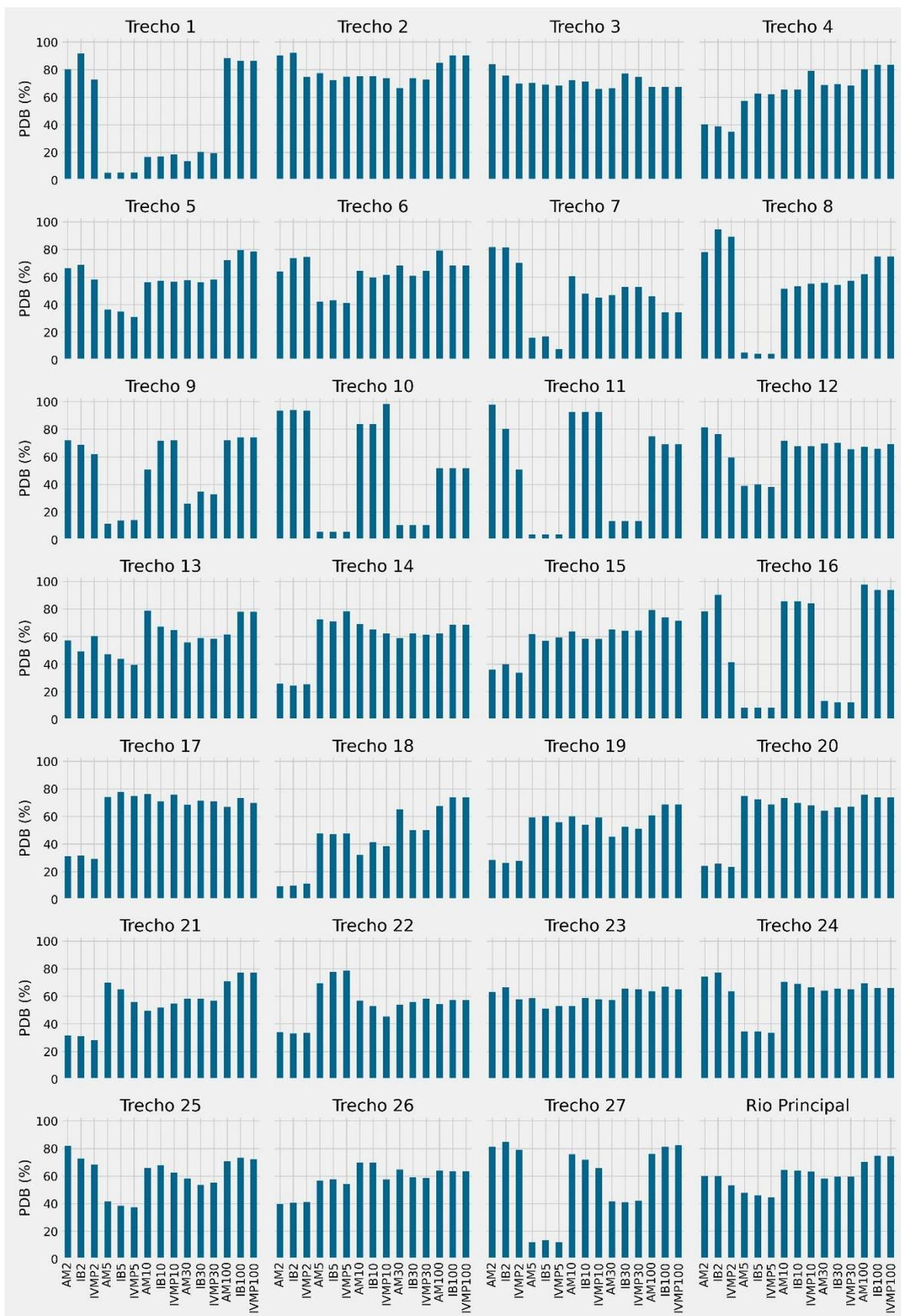
Figura 31 – Percentual dentro do buffer de trechos para métodos de reamostragem: agregação pela média (AM), interpolação bilinear (IB) e pelo vizinho mais próximo (IVMP) nas resoluções de 2, 5, 10, 30 e 100 metros.
