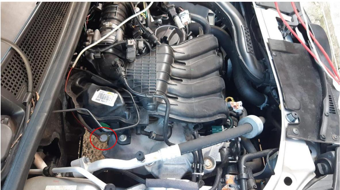
Figura 9 – Posicionamento do Sensor Piezoelétrico no Motor.
