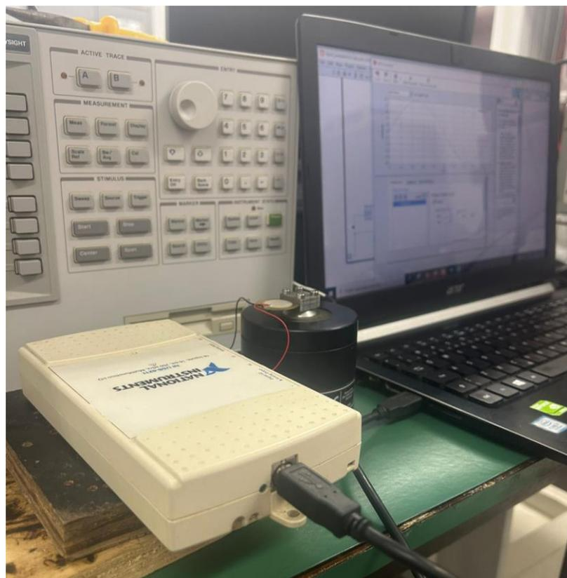
Figura 21 – Equipamentos utilizados para caracterização: Shaker, Notebook e Coletor de dados.
