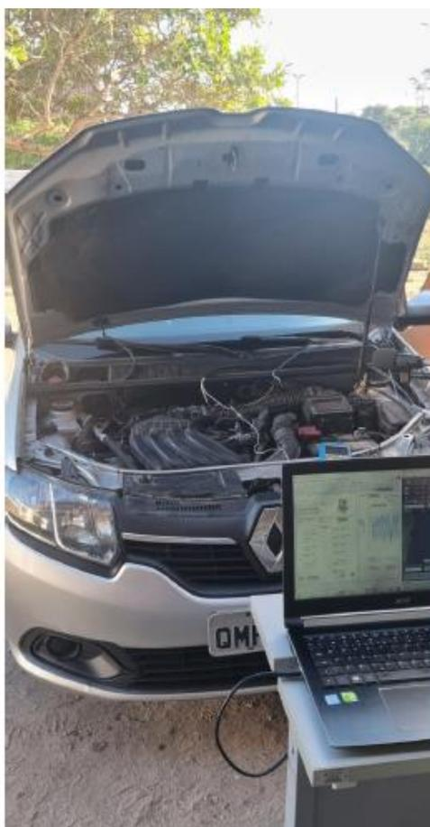
Figura 10 – Veículo instrumentado com equipamento para aquisição de dados.
