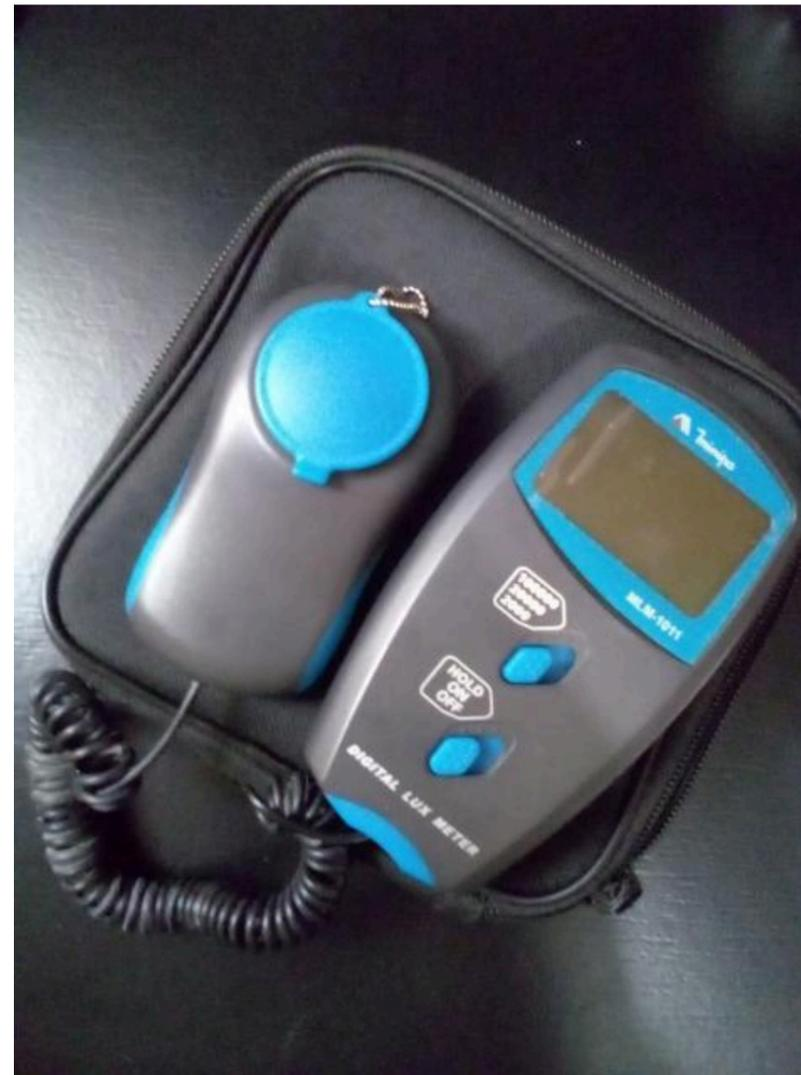
**Figura 03:** Luxímetro modelo MLM - 1011 do fabricante Minipa. O modelo foi utilizado para a coleta de dados do Capítulo 5.
