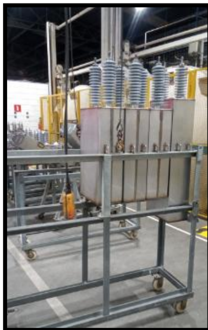
Figura 27 - Posicionamento do capacitor soldado no carrinho
