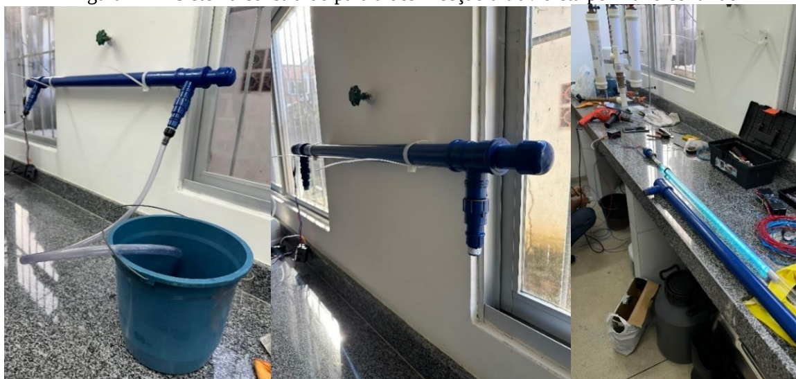
Figura 17 – Sistema construído para a desinfecção ultravioleta por fluxo contínuo
