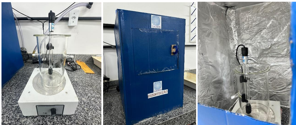
Figura 12 – Sistema da desinfecção em batelada
