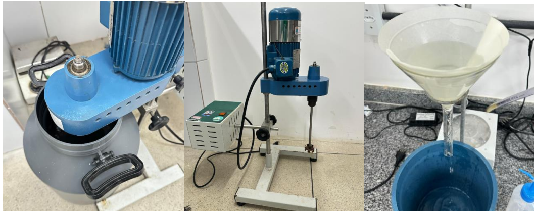
Figura 15 – Sistema mecânico utilizado para coagulação e o sistema de filtração
