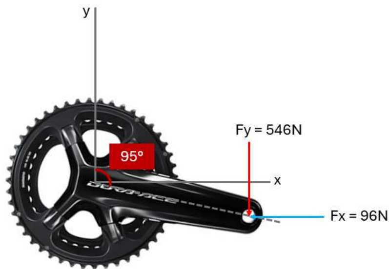
Figura 20 – Cargas máximas no pedal durante uma subida sentado
