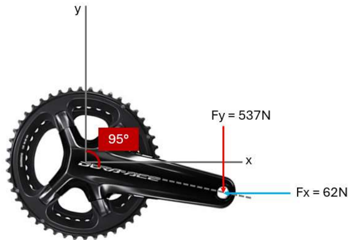
Figura 24 – Cargas máximas no pedal durante uma pedalada no plano
