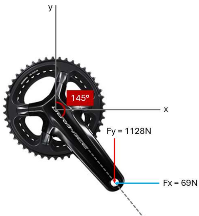
Figura 19 – Cargas máximas no pedal durante uma subida em pé
