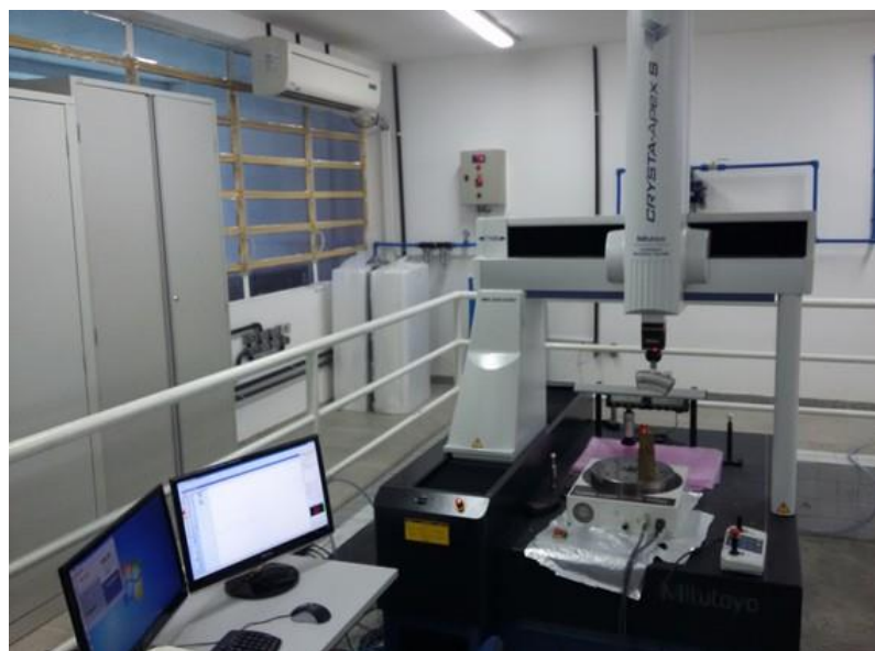
Figura 38– CRYSTA-Apex S7106 do LEP
