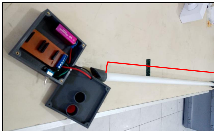
Figura06. Bastão metálico adicionado a câmera multiespectral de baixo custo, LIASER, CCA, UFPB, Areia/PB, 2024.
