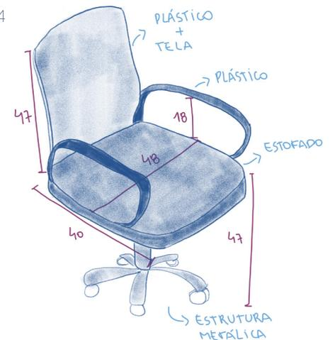
A altura do assento da cadeira 6 é ajustável, mas o apoio de braço é muito baixo e distante, impossibilitando o uso adequado. Usada com uma mesa, quando o assento fica na altura certa, a mesa fica muito alta. Quando o assento fica alto para se adequar a mesa, causa desconforto na perna. Difícil mudar de posição.
