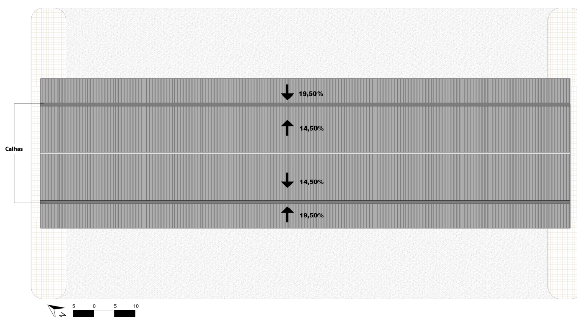
Figura 40 - Planta de cobertura do Mercado Livre do Produtor
