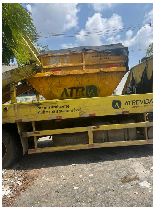
Figura 28. Caçamba com telhas de amianto, sendo recolhida no STI
