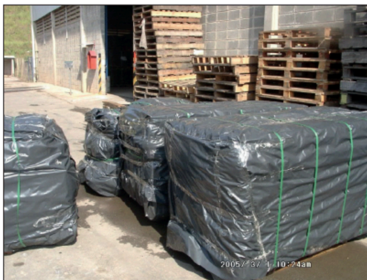
Figura 8. Acondicionamento de peças por duas camadas de polietileno, fixadas com cintas
