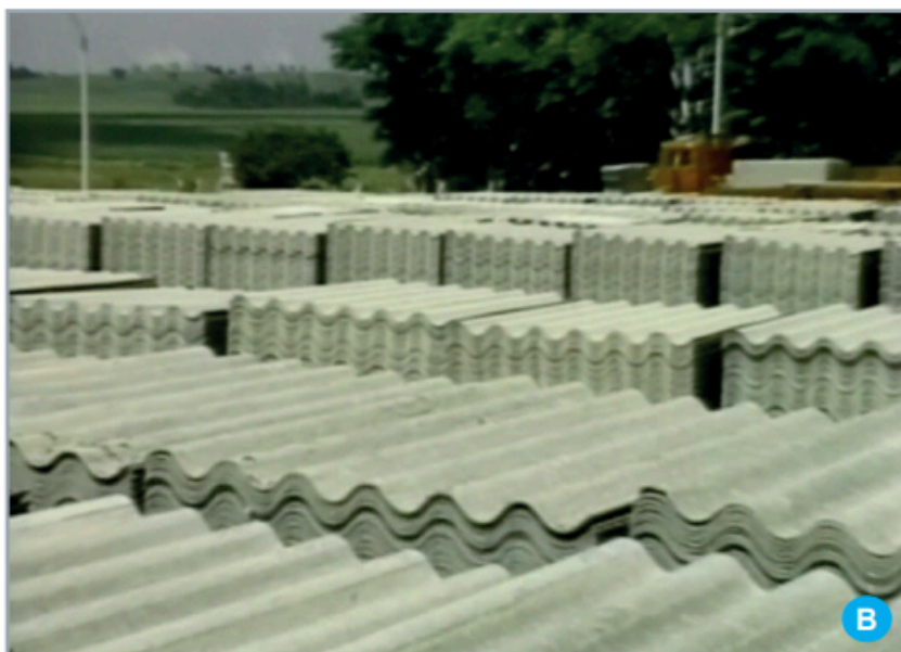
Figura 5. Telhas de Cimento-Amianto
