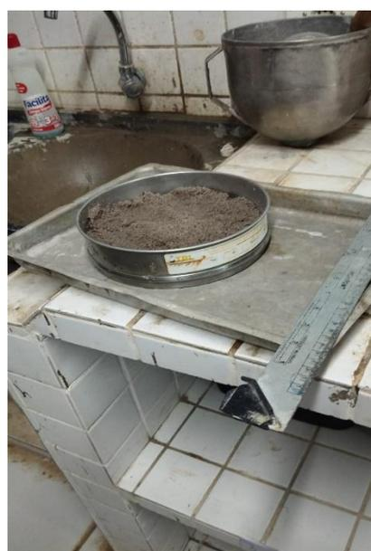
(b) Agregado miúdo saturado superfície seca.
