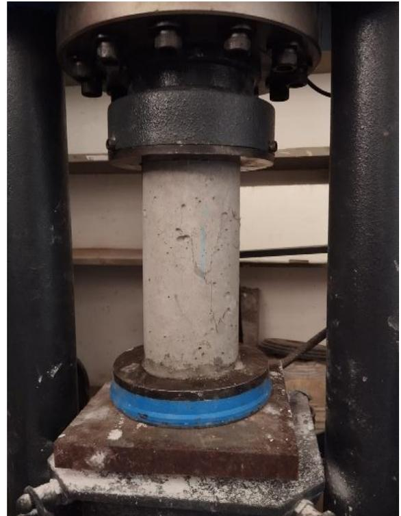
(d) Corpo de prova rompido.
