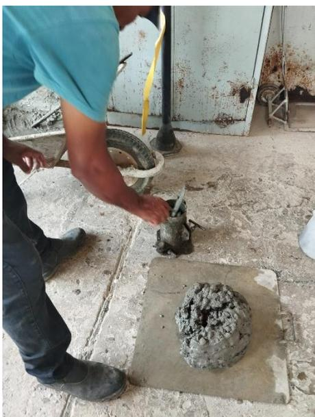
(a) Estado fresco sendo colocado no molde;
