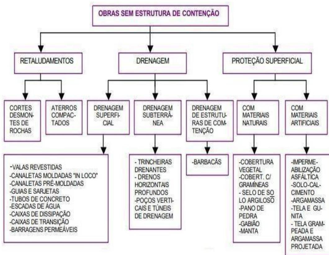
Figura 21 - Tipologia de obras utilizadas na estabilização de encostas
