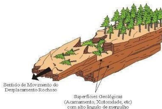
Figura 14 - Esquema para ocorrência de deslocamento de blocos.
