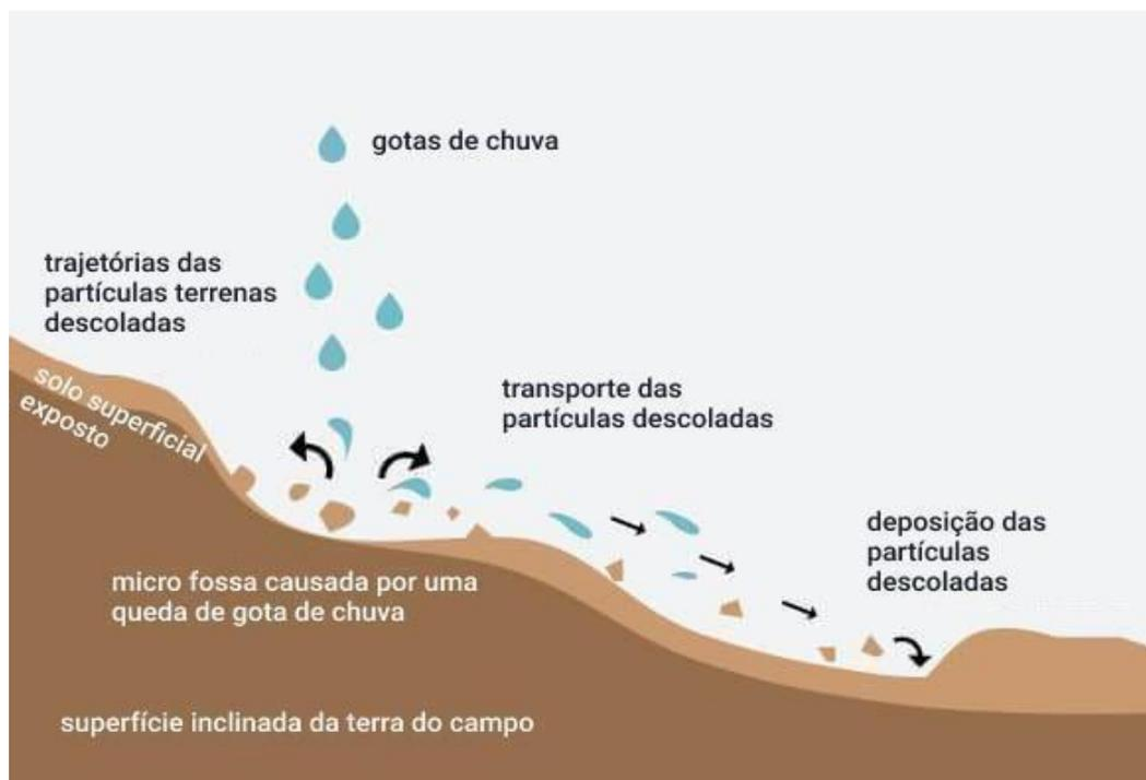
Figura 17 - Esquema da influência do impacto das chuvas causando a desagregação, transporte e deposição das partículas do solo.
